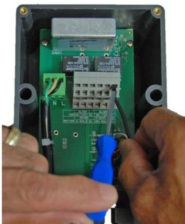
Figure 6 : Connexions électriques sur le bornier (P1)
