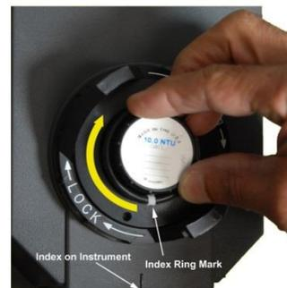
Lorsque vous utiliserez les étalons à l'avenir, insérez toujours l'étalon de manière à ce que l'aiguille de l'anneau d'indexation soit orientée vers l'avant. Tournez lentement l'étalon d'avant en arrière d'environ 5° pour trouver le point le plus bas. L'étalon est maintenant indexé et prêt à l'emploi.
